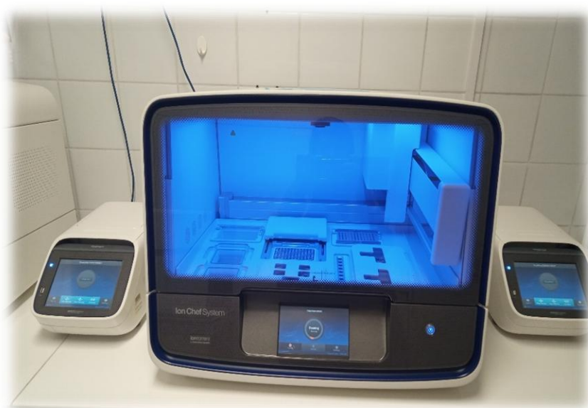
Zdjęcie. Aparat do automatycznego przygotowania bibliotek – Ion Chef System wraz z dwoma termocyklerami SimpliAmp.
